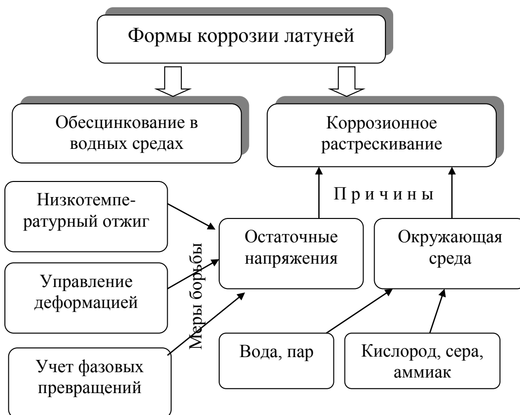
Рис.6.14. Схема воздействий на металл, приводящих к различным формам коррозии латуней
